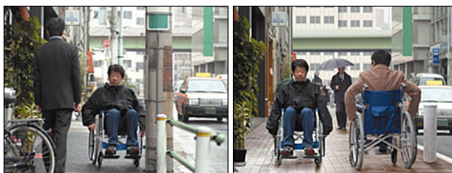
電柱の撤去により幅の広い歩道を整備
