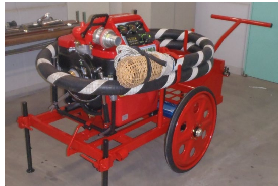
可搬式消防ポンプ
