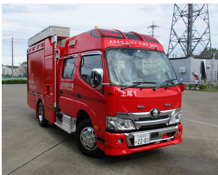
非常用消防ポンプ自動車
