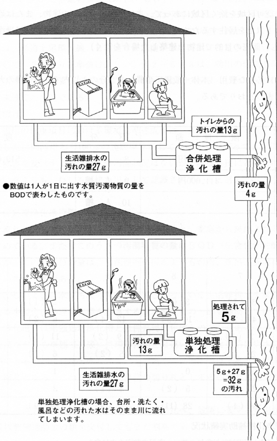
【合併処理浄化槽と単独処理浄化槽】
