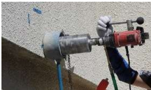
柱や梁のコンクリート内部の状況や建物の劣化等を確認する躯体の健全性調査
