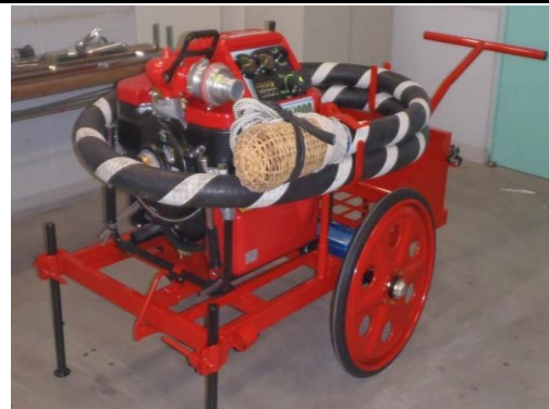
可搬式消防ポンプ
