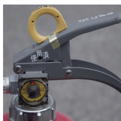
× 表示装置の脱落
