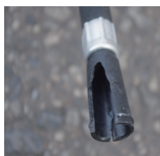
× ノズルの破損
