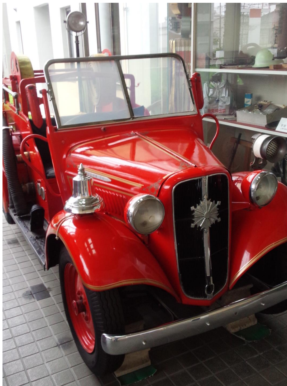
※消防本部ロービーに展示 1949年式ダットサン小型消防ポンプ自動車 全長 3200 mm 全幅 1400 mm 全高 1750 mm 最低地上高 200 mm
