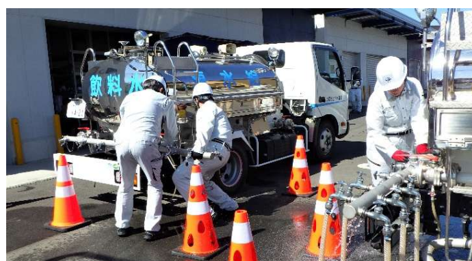
4.給水車に蛇口を増設し、応急給水
