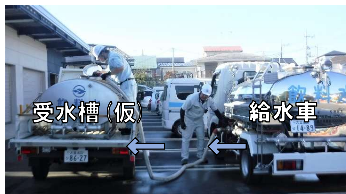
4.給水車から可搬式応急給水タンクへの圧送
