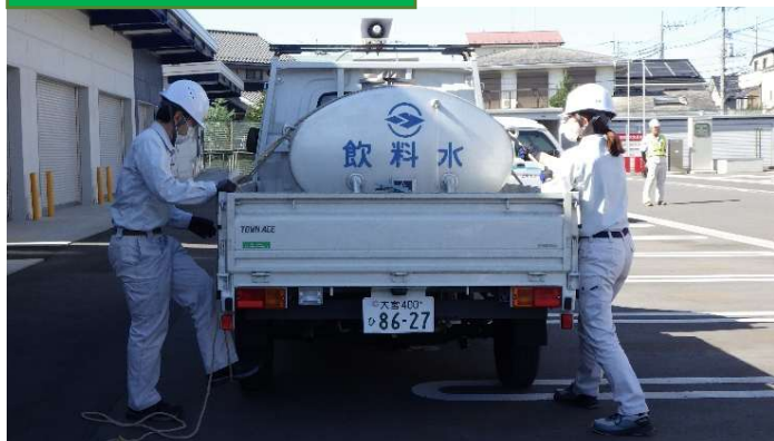
1.可搬式応急給水タンク積載
