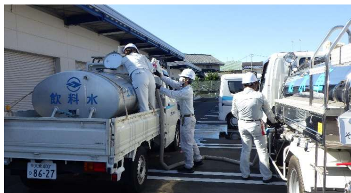
3.給水車から可搬式応急給水タンクに注水するホースをセット
