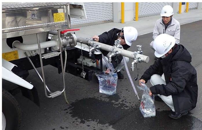
給水車に蛇口を増設し、非常用給水袋に注水
