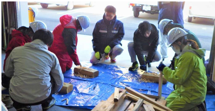
角材を削り出し、木栓に加工
