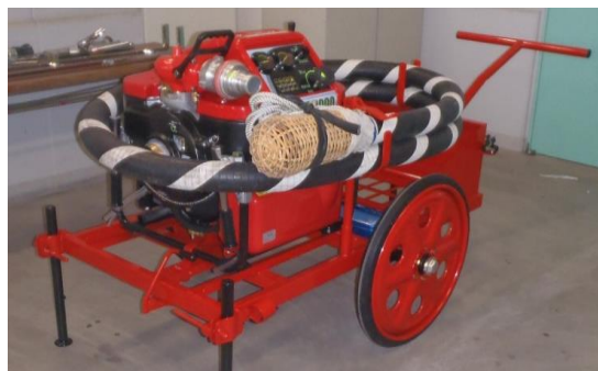
可搬式消防ポンプ
