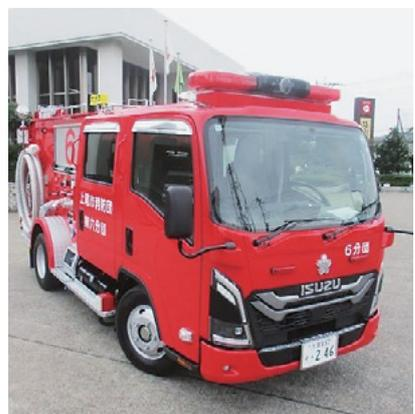
ための水を汲み上げるポンプの役割を果たし、消火栓や貯水槽の水を毎分2千リットル以上、地上30メートルの高さまで放水できる高圧ポンプを内蔵しています。
