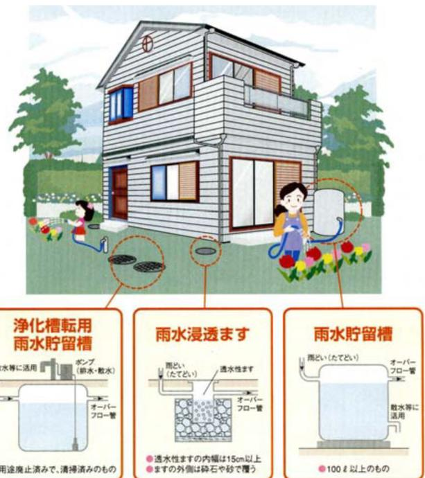
図 4-3 各戸の貯留浸透施設のイメージ
